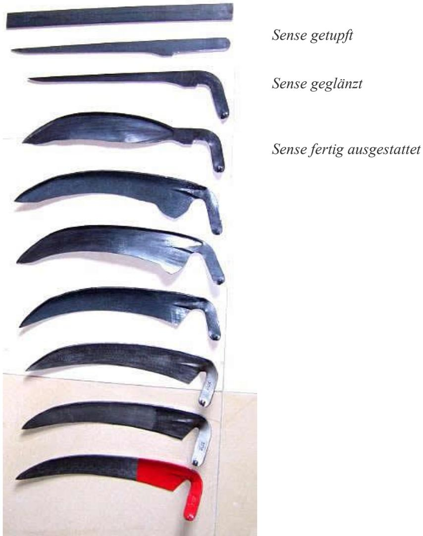
Wie bei der Sense beginnt die Fertigung der Sichel ebenfalls mit dem Abschneiden des Bröckel. Danach folgen die Schmiedearbeiten: Spitze schmieden, Angel ausrecken, Breiten, Glattschmieden, Abschneiden und zum Schluss das Aufsetzen des Griffes. Die Musterstücke wurden uns angefertigt im Freundenthaler Sensenhammer.
