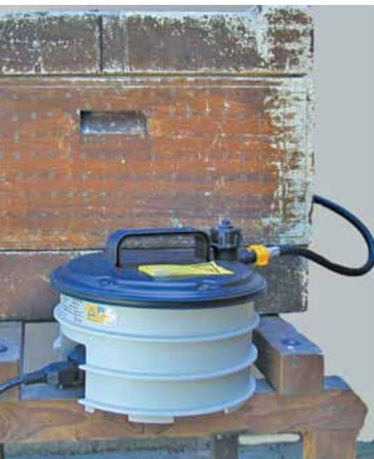
Ein kleiner Dampfgenerator und Styropor-Magazine (bzw. -Kisten) ergeben einen preisgünstigen Wachs-schmelzer.
