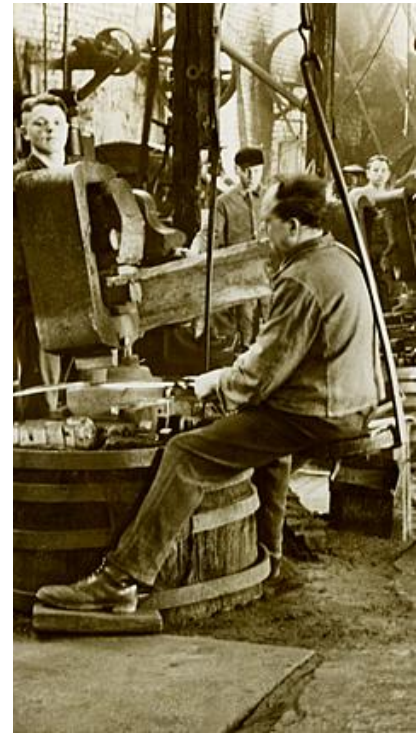
Müscheder Sensenschmiede auf dem Sophienhammer bei ihrer Arbeit (Recken, Breiten, Glattschmieden, Klippen, Schleifen, Polieren, Lackieren, Versand) . Die Lehrlinge schauen den erfahrenen Sensenschmieden über die Schulter. Original: Firma Cronenberg, Müschede.
