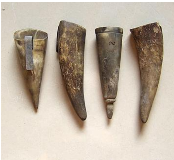
Wetzsteinbecher aus Kuhhorn (l.), aus Metall, gelötet (r.).
