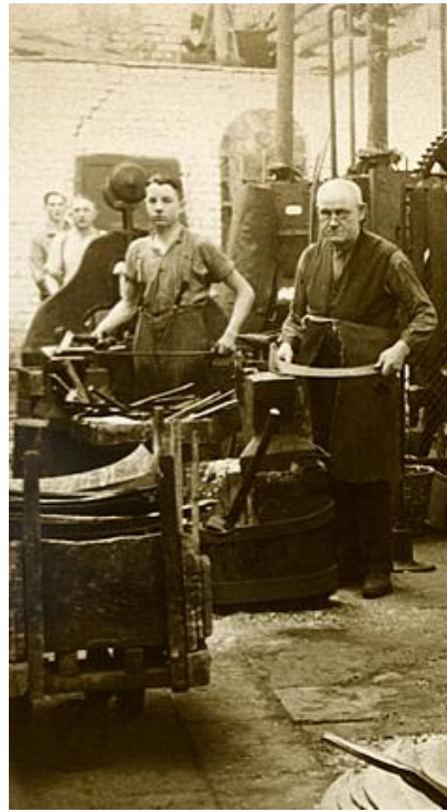
Müscheder Sensenschmiede auf dem Sophienhammer bei ihrer Arbeit (Recken, Breiten, Glattschmieden, Klippen, Schleifen, Polieren, Lackieren, Versand) . Die Lehrlinge schauen den erfahrenen Sensenschmieden über die Schulter. Original: Firma Cronenberg, Müschede.
