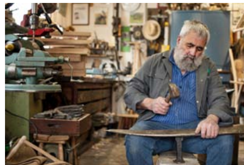
Hansjörg von Känel beim Dengeln eines Sennenblattes. Mit Hämmern wird die Schneide wieder scharf gemacht – einen Zehntelmillimeter dünn.
